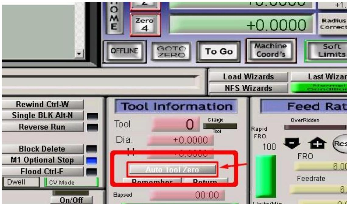
6 - Copie o código “[Script Auto Tool Zero – MKNTech](#)” para o macro de sonda de zeramento de ferramenta. Certifique-se de parametrizar as variáveis conforme sua necessidade para a sonda de zeramento de ferramenta movê-la para a posição que deseja.
