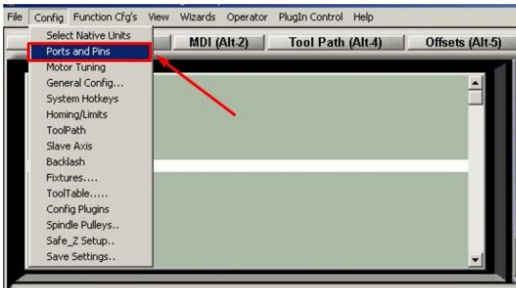
3 - Configure a entrada da sonda de zeramento de ferramenta, inserindo o número do pino correspondente e selecionando a opção "Ativar".
